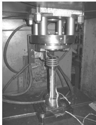
Рис. 4. Установка для процесу сумісного витягування
