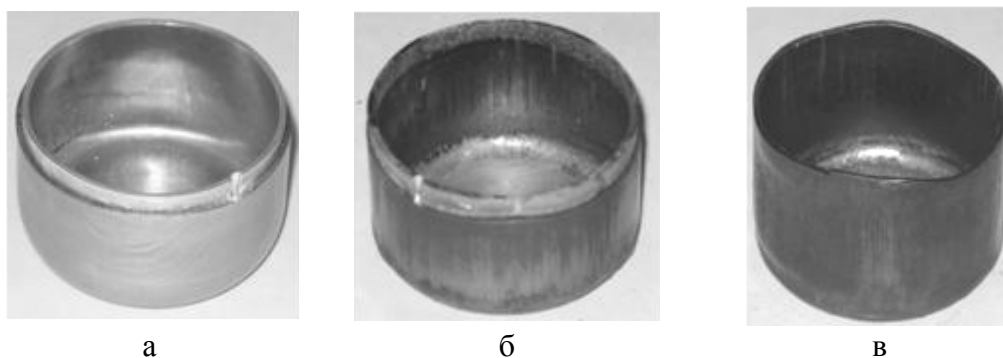
Рис. 5. Двошарові елементи системи Сталь – Al: а – перший перехід без потоншення; б та в – відповідно другий та третій переходи з потоншенням
